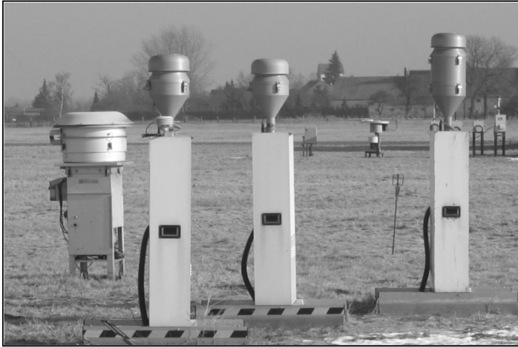
Abb. 2 Der Sierra-Anderson HV-Sammler für PM_{10} (links) und die drei DIGITEL HV-Sammler für PM_{10} , PM_{2.5} und PM_1 (rechts) im Jahr 2003 an der Station Melpitz
