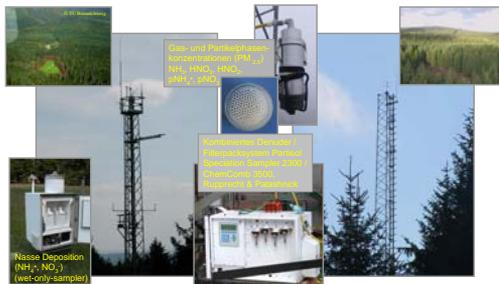
Abb. 2: Links: Ankerstation Tharandter Wald, Gesamtansicht und Messturm (42 m); Rechts: Ankerstation Oberbärenburg, Überblick und Messturm (30 m), sowie Messprogramm für Stickstoffspezies
